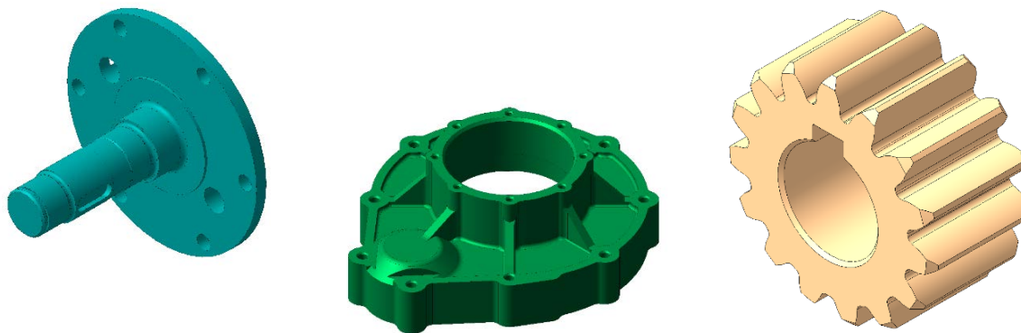
Рисунок 13 – 3D-модели деталей редуктора
